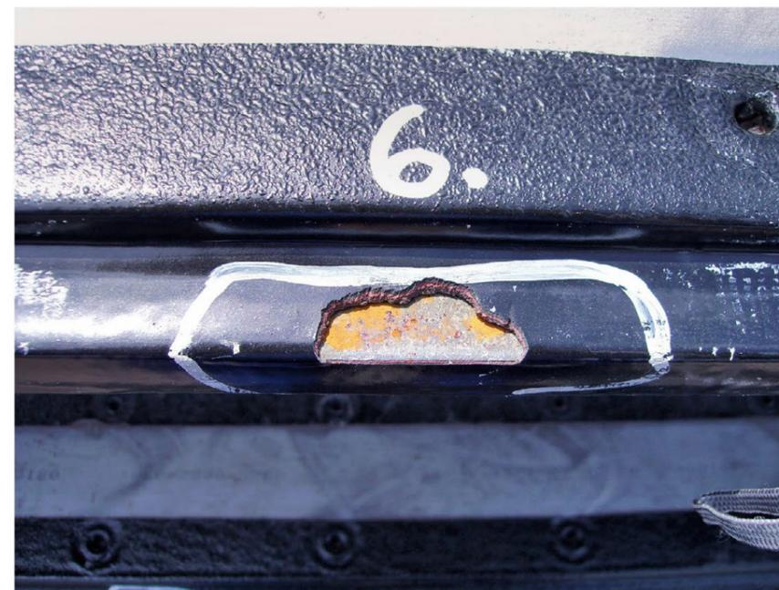
Bild 2: Abplatzung an einer Korrosionsschutzbeschichtung
